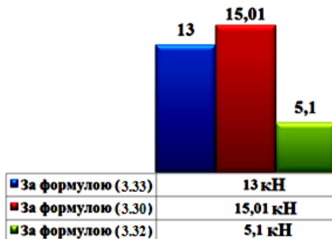
Рисунок 3.20 – Направляюча сила на першій колісній парі отримана за різними методиками при швидкості руху 30 м/с
