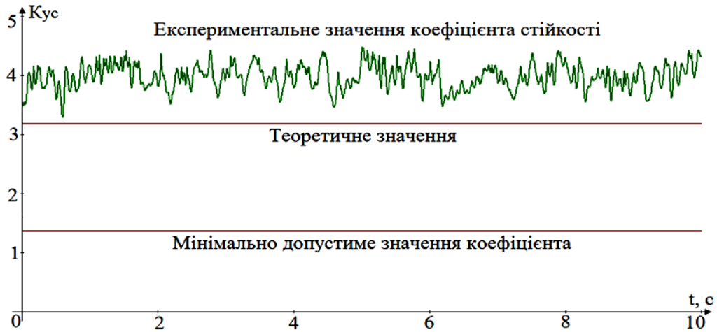
Рисунок 4.12 – Порівняння експериментальних значень коефіцієнта запасу стійкості від сходу колеса з рейки першої колісної пари вагона дизель-поїзда при швидкості руху 30 м/с у прямій ділянці залізничної колії з теоретично розрахованими
