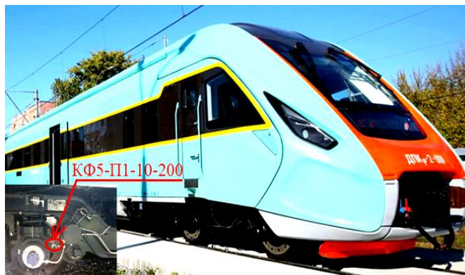
Рисунок 3.21 – Приклад розміщення тензорезистора типу КФ5-П1-10-200 на вагоні дизель-поїзда ДПКр-2
